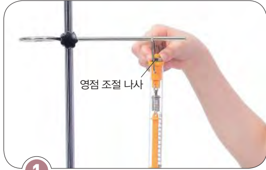
1 영점 조절 나사를 이용해 표시 자를 눈금의 '0'에 맞춥니다.
