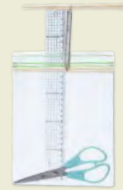
▲ 용수철저울의 원리를 이용한 저울
